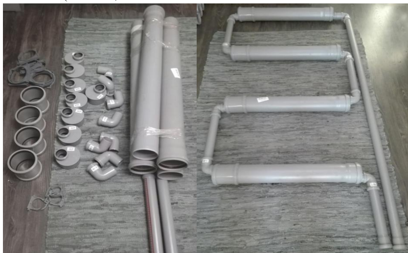
Рисунок 26 - Подготовка труб и сбор каркаса установки
