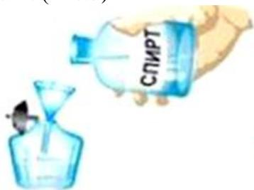
**Рисунок 2 – Заполнение резервуара спиртом**
